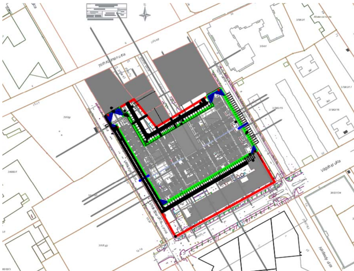
2. ábra– A tervezett mélygarázs munkatérhatárolásának kontúrja (zöld), telekhatár (piros)
